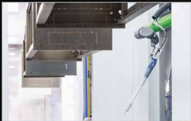
Automatizovaný stříkáč box práškové lakovny
