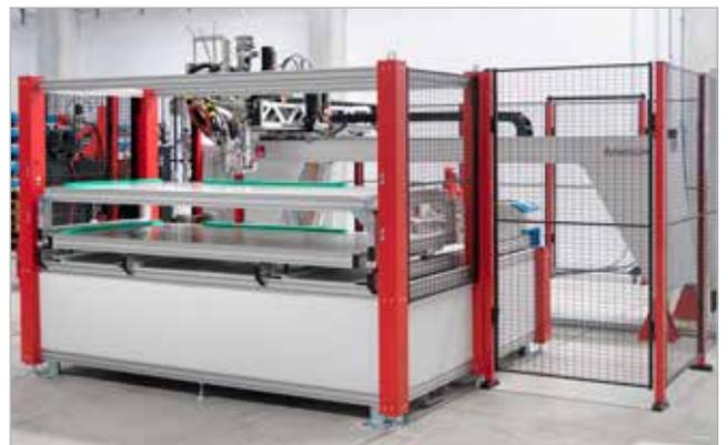
Zentrum zum Einkleben des Türglases und Fertigung der Türdichtungen
