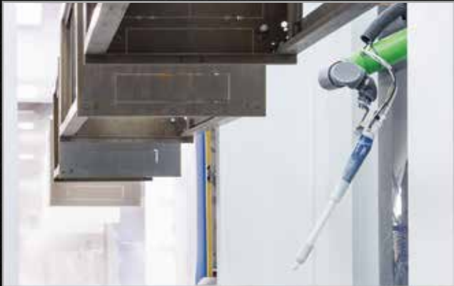
Spritzautomat in der Pulverlackiererei
