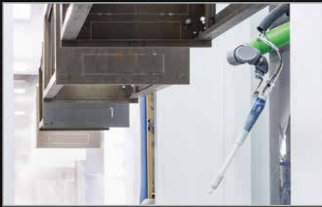
Spritzautomat in der Pulverlackiererei
