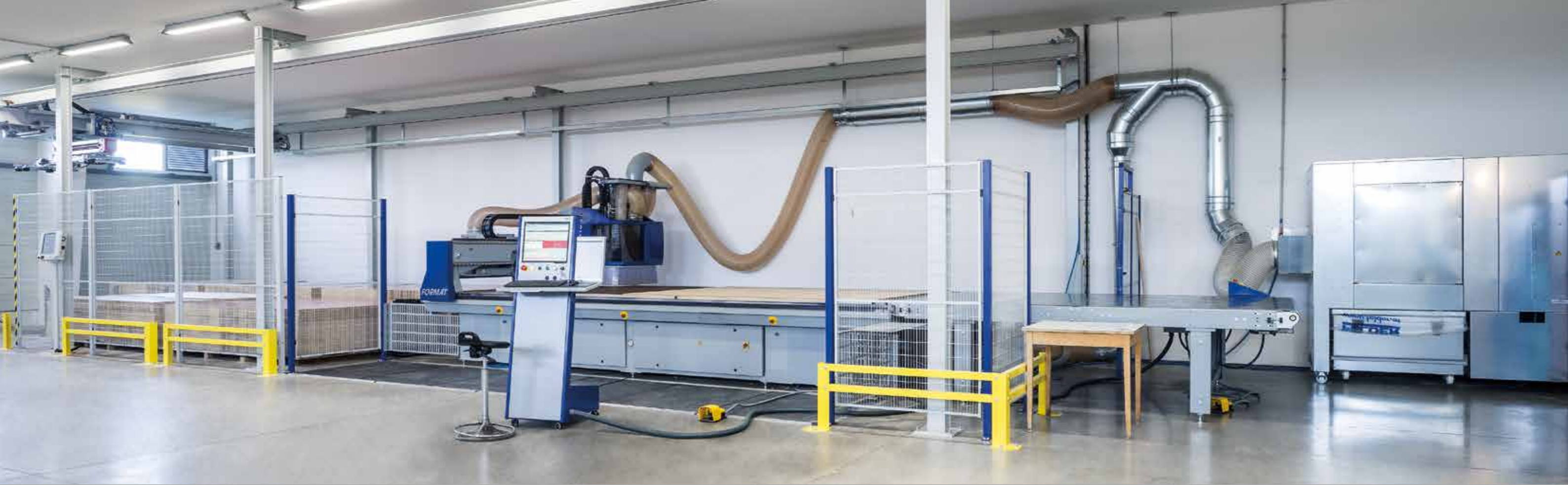
Vollautomatisches Nesting-CNC-Bearbeitungszentrum mit Vorschubapparat
